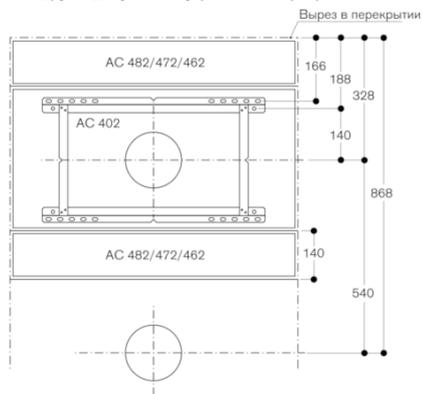
AC 402 с модулем циркуляции воздуха
