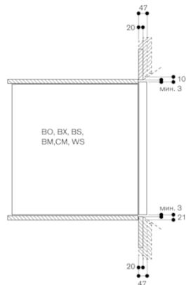
Поперечный разрез, зазоры сверху и снизу дверцы
